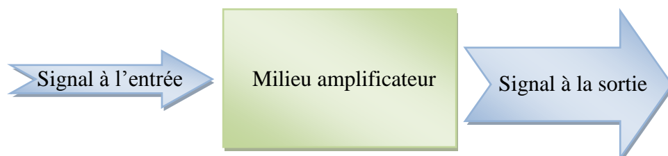
Figure (2.8): Schéma de principe d'un amplificateur optique
