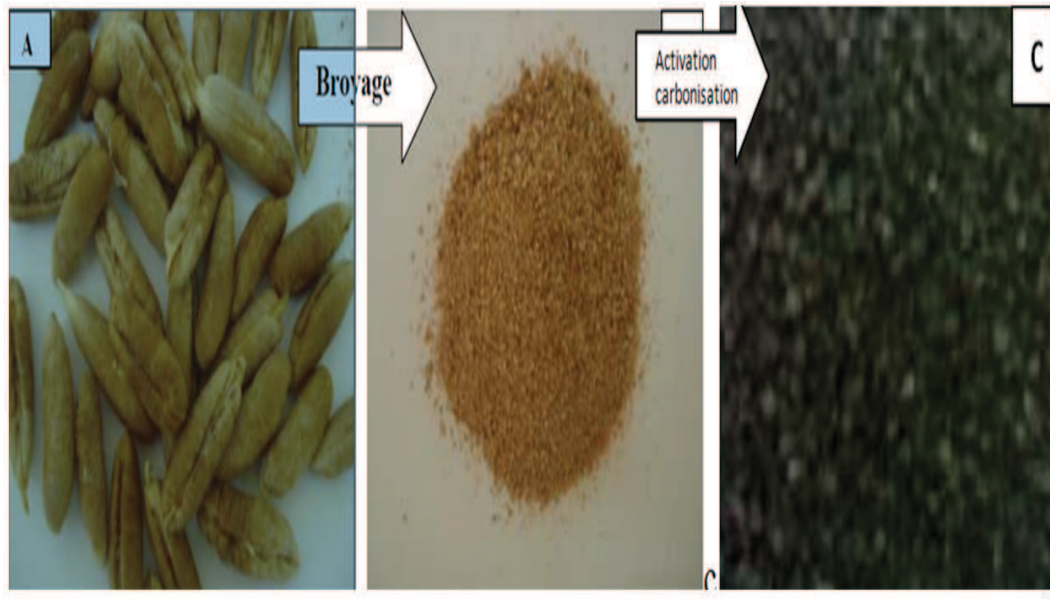
FIGURE 3.3: Les étapes de préparation de charbon actif à partir des noyaux de dattes.
