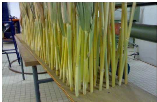
Figure 2.2.4 : Plaque d'essais avec une densité de 8U/dm^2 , ( \varnothing = 10 mm).
