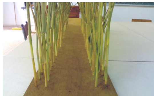
Figure 2.2.2 : Plaque d'essais avec une densité de 4U/dm^2 , ( \varnothing = 6 mm).
