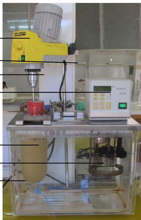
**Figure II. 2: Installation de l'extraction**
