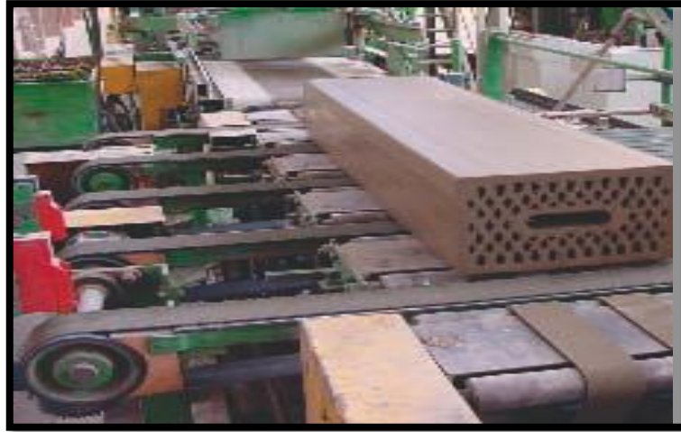
Figure. I.15 Production de briques étirées [4]
