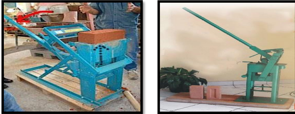
Figure (I.9) (I.10) : Brique de terre crue compressée réalisée à l'aide d'une presse manuelle [7].
