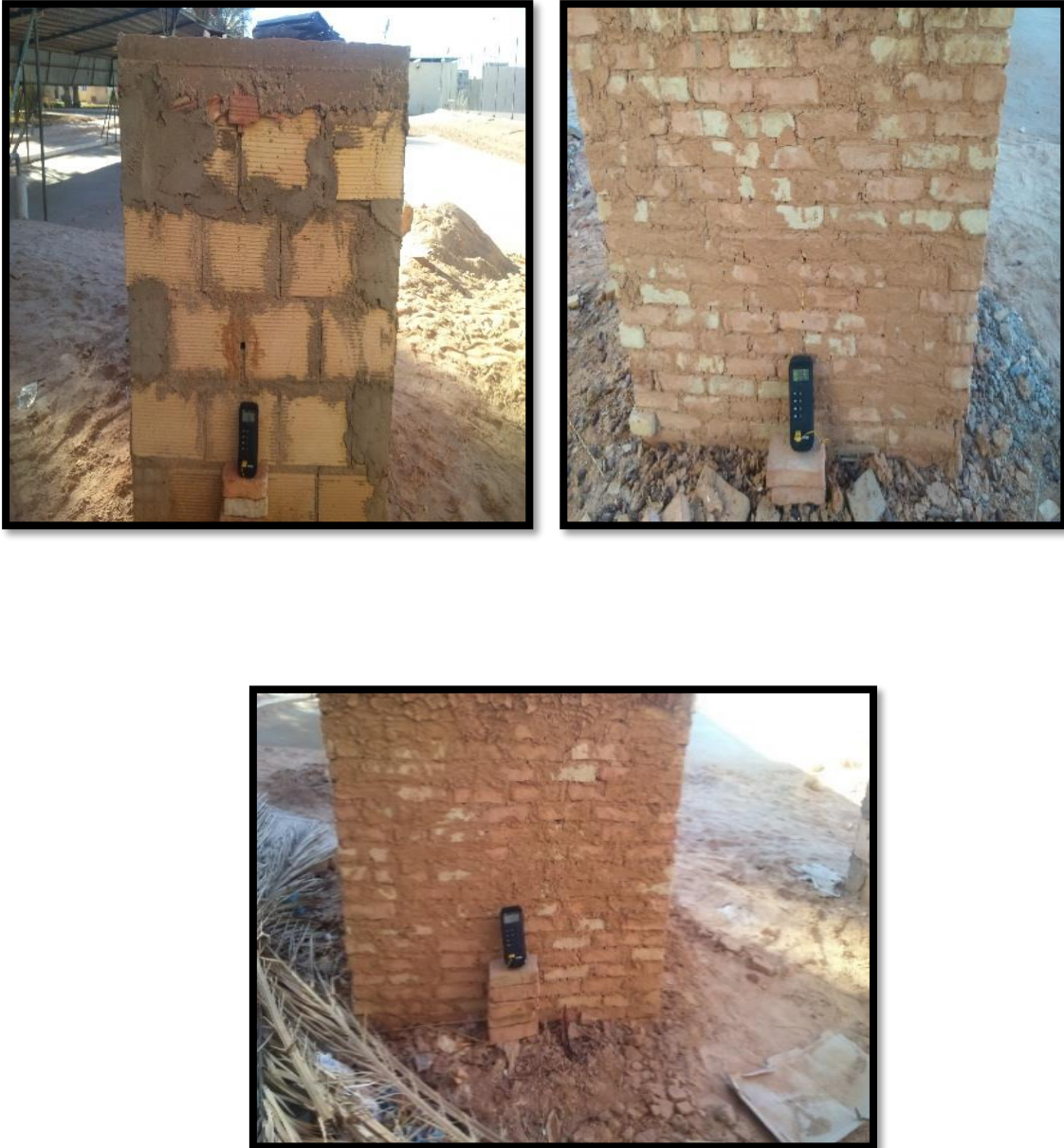
Figure IV.24 : Mesure de la température externe et interne et l'humidité.
