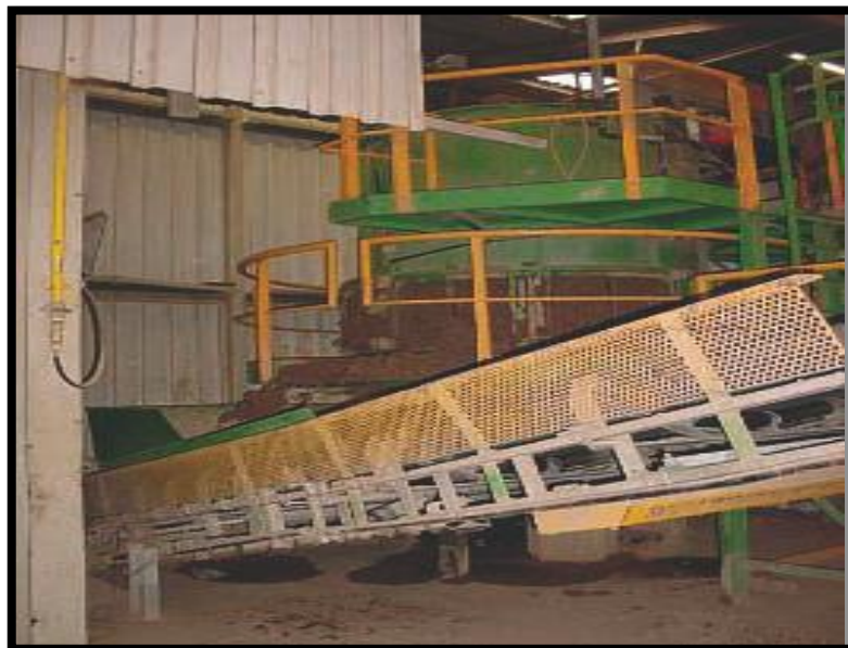
Figure. I.13 Broyage et malaxage de l'argile [4]
