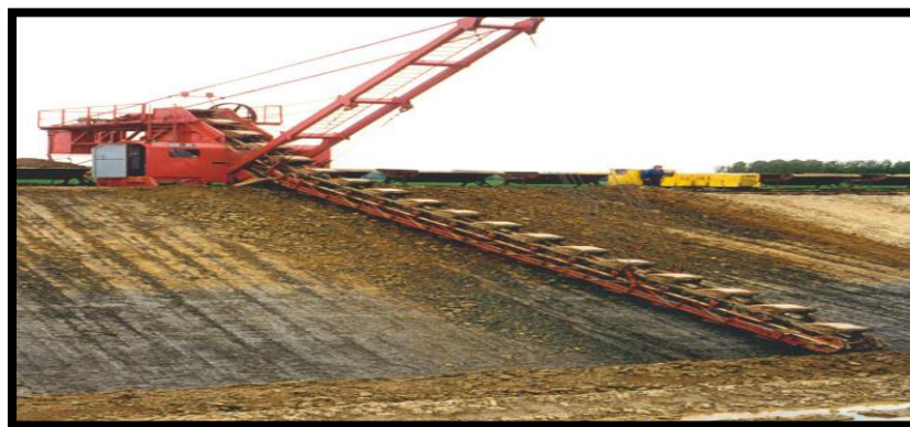
Figure. I.12 Extraction de l'argile [4]
