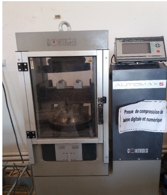
Photo II.A4. Dispositif d'essai par flexion
