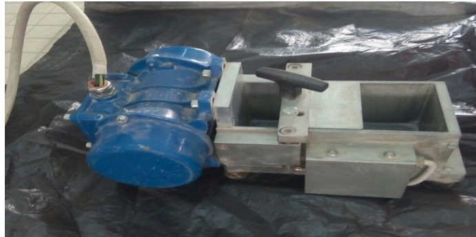
Photo II.A2. Essai de maniabilité (Maniabilimètre)
