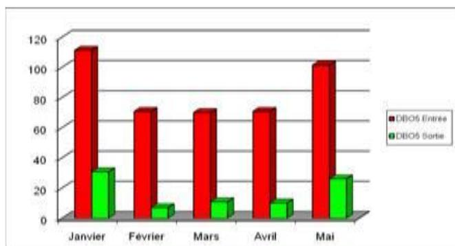
Figure 1 : Evolution (en mg/l) de la DBO<sub>5</sub> des eaux à l'entrée et à la sortie du la station d'épuration
