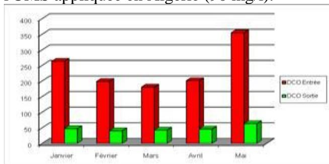
Figure 3: Evolution (en mg/l) de la DCO des eaux à l'entrée et à la sortie du la station d'épuration
