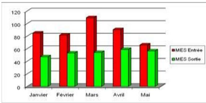
Figure 5 : Evolution (en mg/l) des MES des eaux à l'entrée et à la sortie de la station d'épuration
