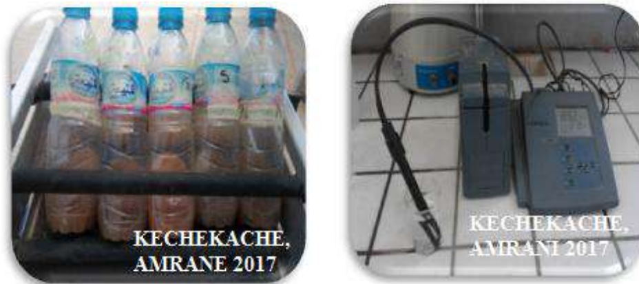
Photo(21) : Préparation d'extrait de sol 1/5 et mesure de pH à l'aide d'un pH-mètre.
