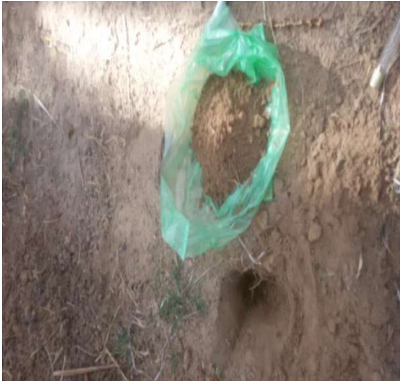
Photo 01 : prise d'échantillon de sol
