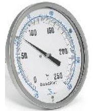
Figure III.3 : Thermomètre bilame d'Ashcroft (série CI)
