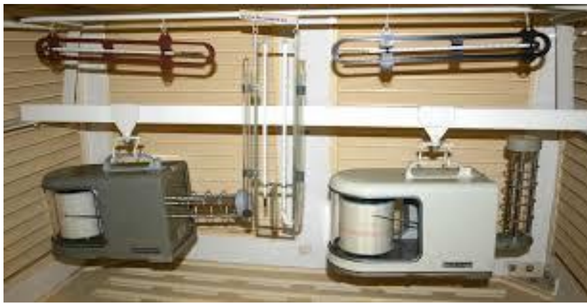
الشكل رقم (01-II) يمثل ترمومترات لقياس درجة الحرارة [02]
