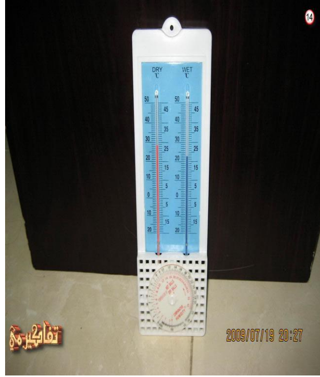
الشكل رقم (02-II) يمثل جهاز الهيجرومتر [13] الشكل رقم (03-II) يوضح جهاز الهيجروجراف [13]
