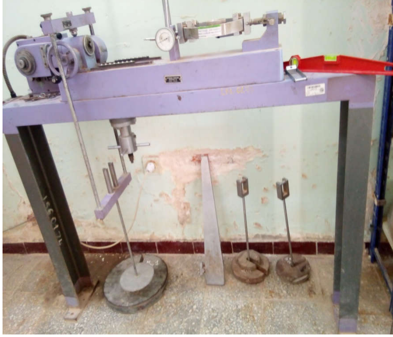
الشكل (II-8): يمثل جهاز القص المباشر
