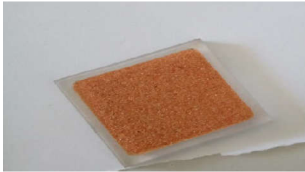
الشكل (III-6): الأداة المستخدمة لتحضير العينة للقياس XRD
