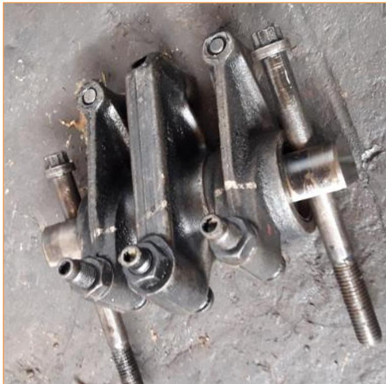
Fig. II.14: Les doigts du culbuteur.
