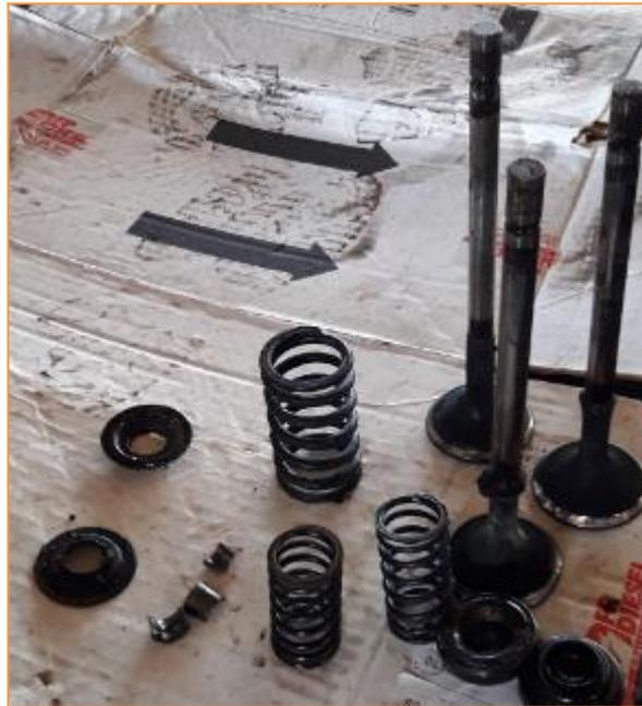
Fig. II.13: Les soupapes et ses accessoires
