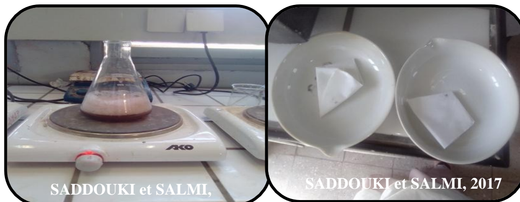
Photo (15) : Dosage de gypse
