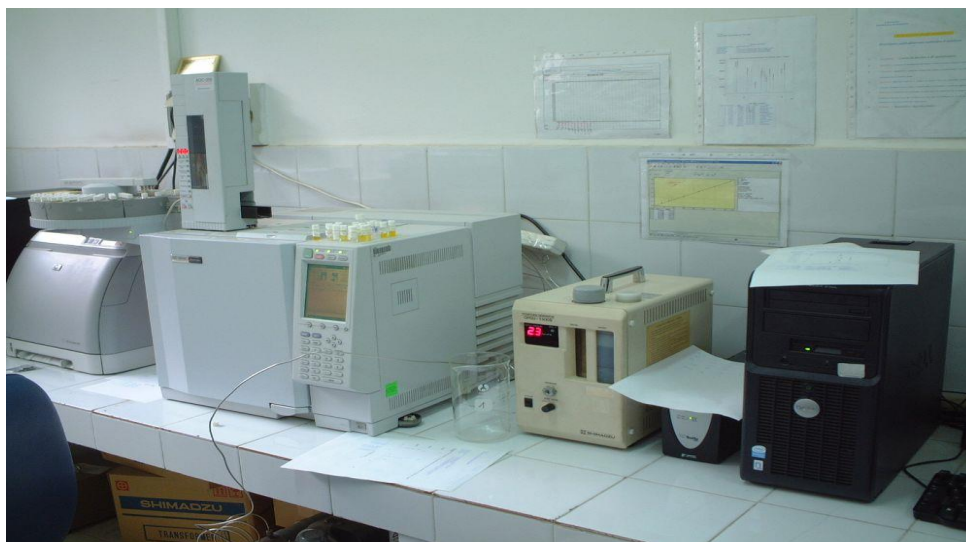
Figure 29: Chromatographe avec un Détecteur à Photométrie de Flamme (GC-FPD) «Pour détecter les Organophosphoré »
