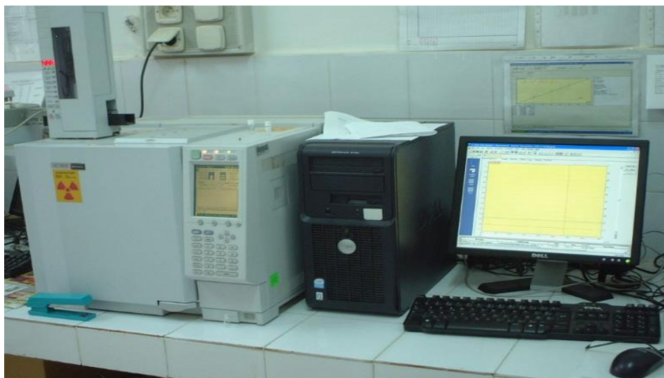
Figure 28 : Chromatographe avec un Détecteur à Capture d'Electron (GC/ECD) « Pour détecter les Organochlorés »
