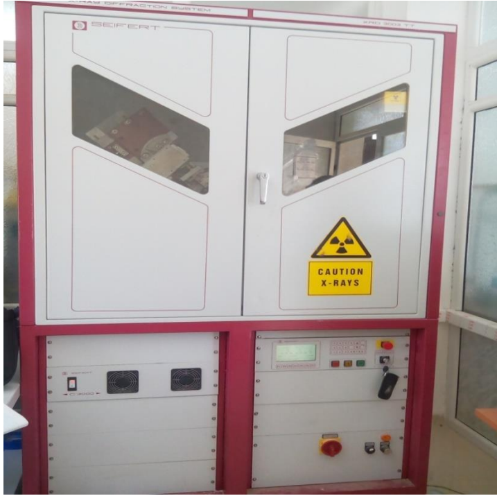
الشكل II-19: صورة لجهاز انعراج الأشعة السينية.
