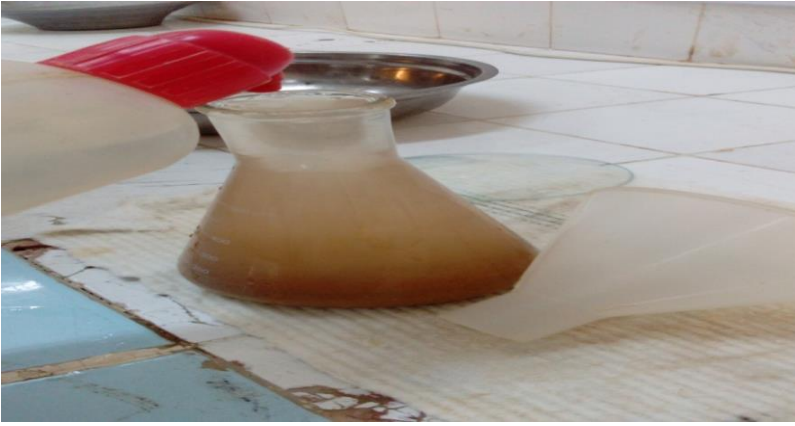
الشكل II-8: صورة توضح تجربة الكتلة الحجمية المطلقة
