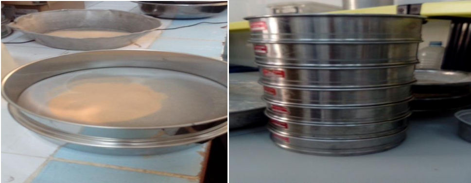
الشكل II-9: صورة توضح المناخل المستعملة في تجربة التدرج الحبيبي.
