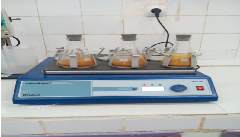
الشكل II-14 : جهاز الرج بالاهتزازات.
