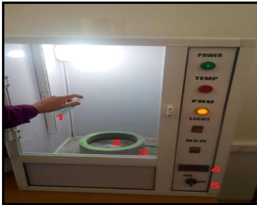
الشكل (1.III): التركيب التجريبي المستخدم لتحضير الاغشية الرقيقة بتقنية الرش الكيميائي الحراري.
