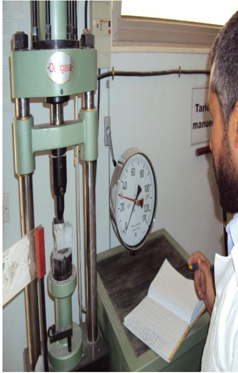
الصورة (2-IV) توضح شكل آلة التحطيم الخاصة بتجربة الضغط .
