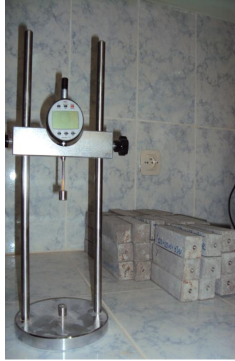
الصورة (4-IV) توضح شكل آلة قياس الانكماش .
