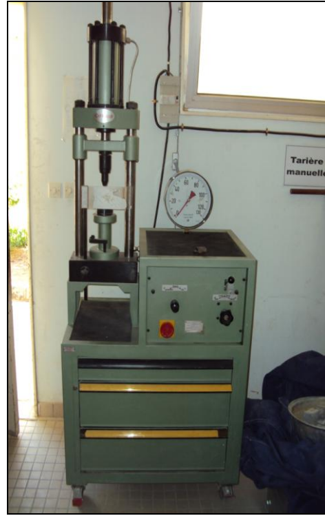
الصورة (2-IV) توضح شكل آلة التحطيم الخاصة بتجربة الضغط .
