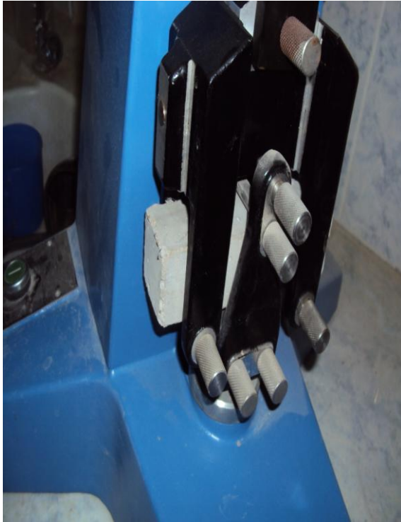
الصورة (1-IV) توضح شكل آلة التحطيم الخاصة بتجربة الانحناء .
