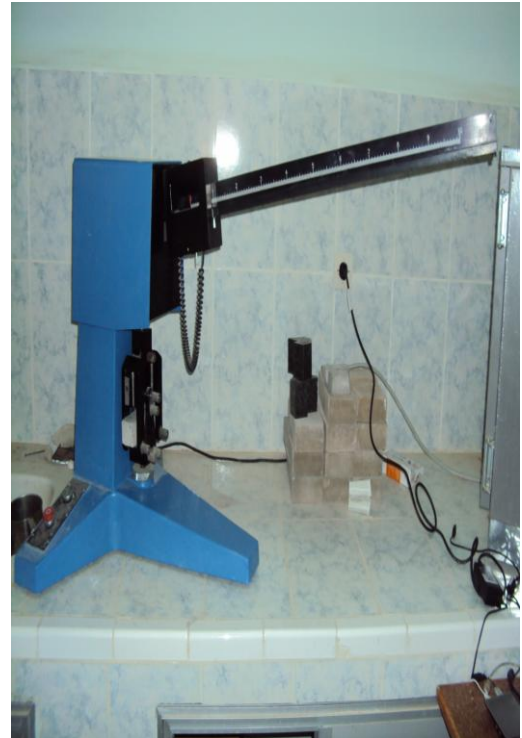
الصورة (1-IV) توضح شكل آلة التحطيم الخاصة بتجربة الانحناء .
