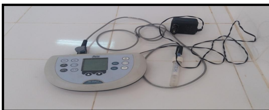
Fig.25 : appareil de conductivimètre
