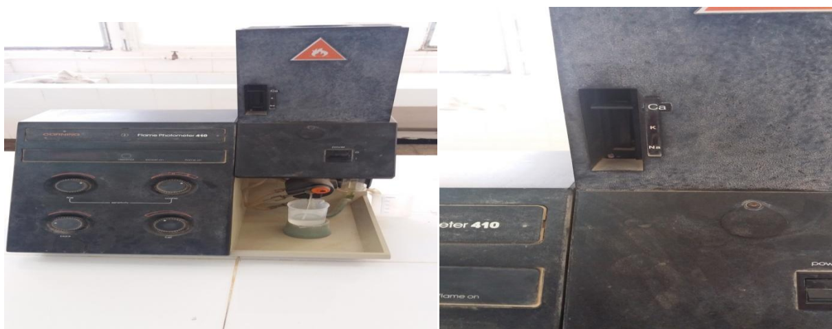
Fig.27 : appareil de flamme photomètre 410 pour mesure les cations
