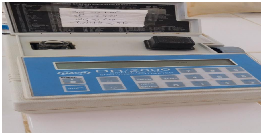
Fig.28 : appareil DR 2000 pour mesure les anions
