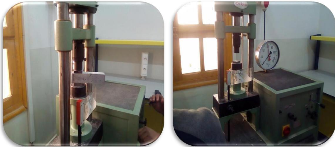
**Photo (II.11).** Essai de compression.
