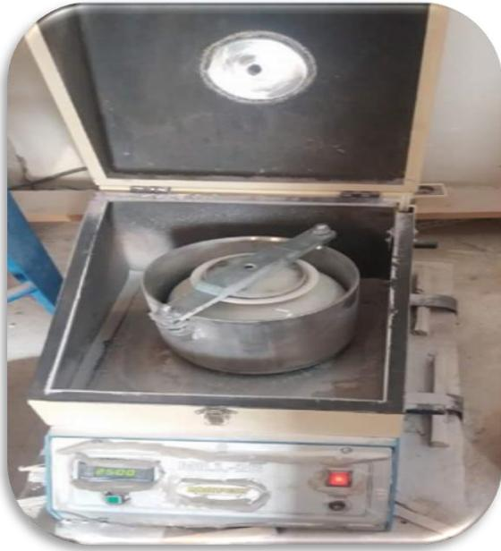
Photo 01: Appareille de broyage.
