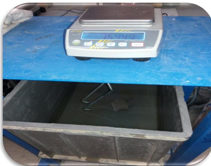
**Photo (II.9).**essai de la porosité.
