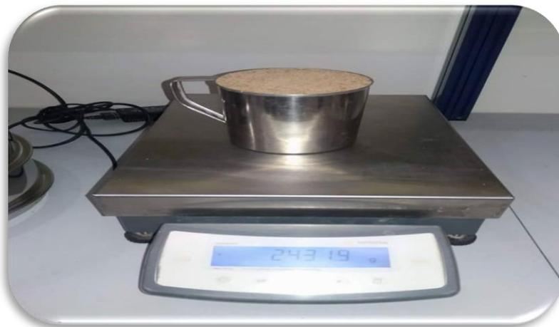
**Photo (II.2).**Essai la masse volumique apparente.
