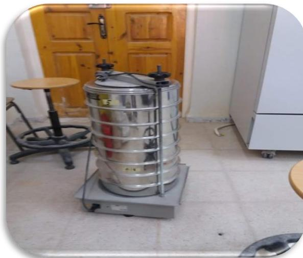
**Photo (II.3).** Machine d'Analyse Granulométrique Par Tamisage.
