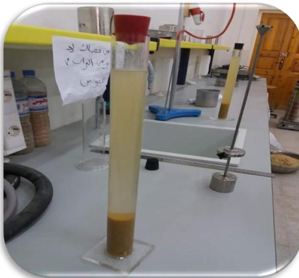
**Photo (II.1).** Essai d'équivalente de sable.
