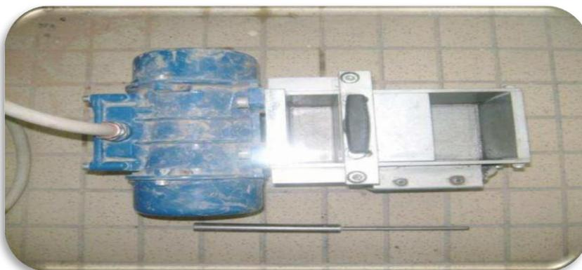
**Photo II.(6).** Maniabilimètre de mortier.
