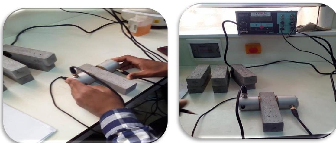
Photo (II.8).essai de Vitesse de propagation d'ondes ultrasoniques.
