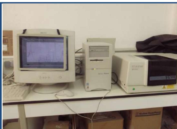
Spectromètre infrarouge à transformée de Fourier (IRTF).
