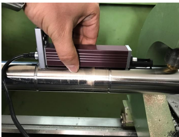
Figure III.5: Principe de mesure de la rugosité.
