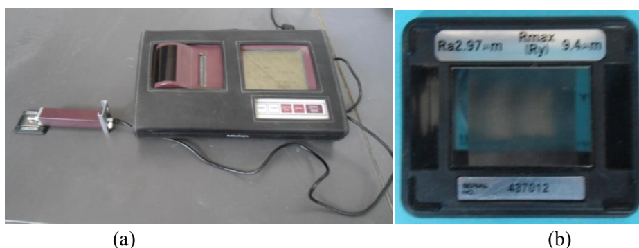
Figure III.4 : (a) Rugosimètre MITUTOYO, (b) étalon d'étalonnage du rugosimètre.
