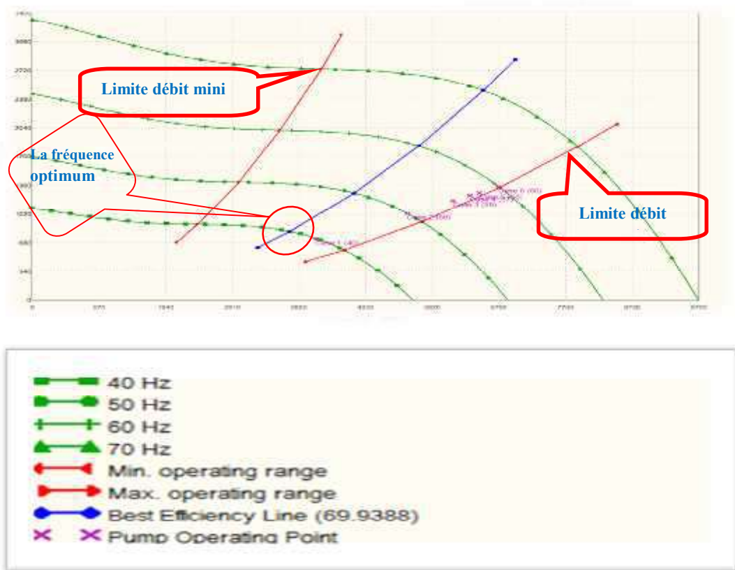
Figure.III.10 : Plage de fonctionnement de pompe ESP pour le choix de la fréquence
