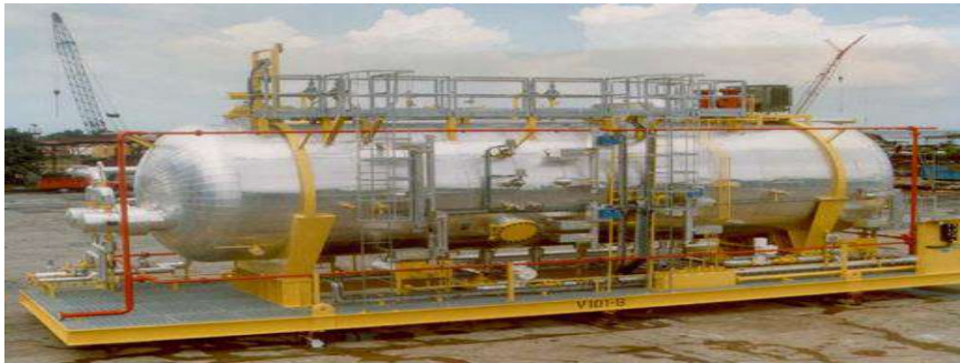
Figure III.9: Vue extérieure d'un dessaleur électrostatique.
