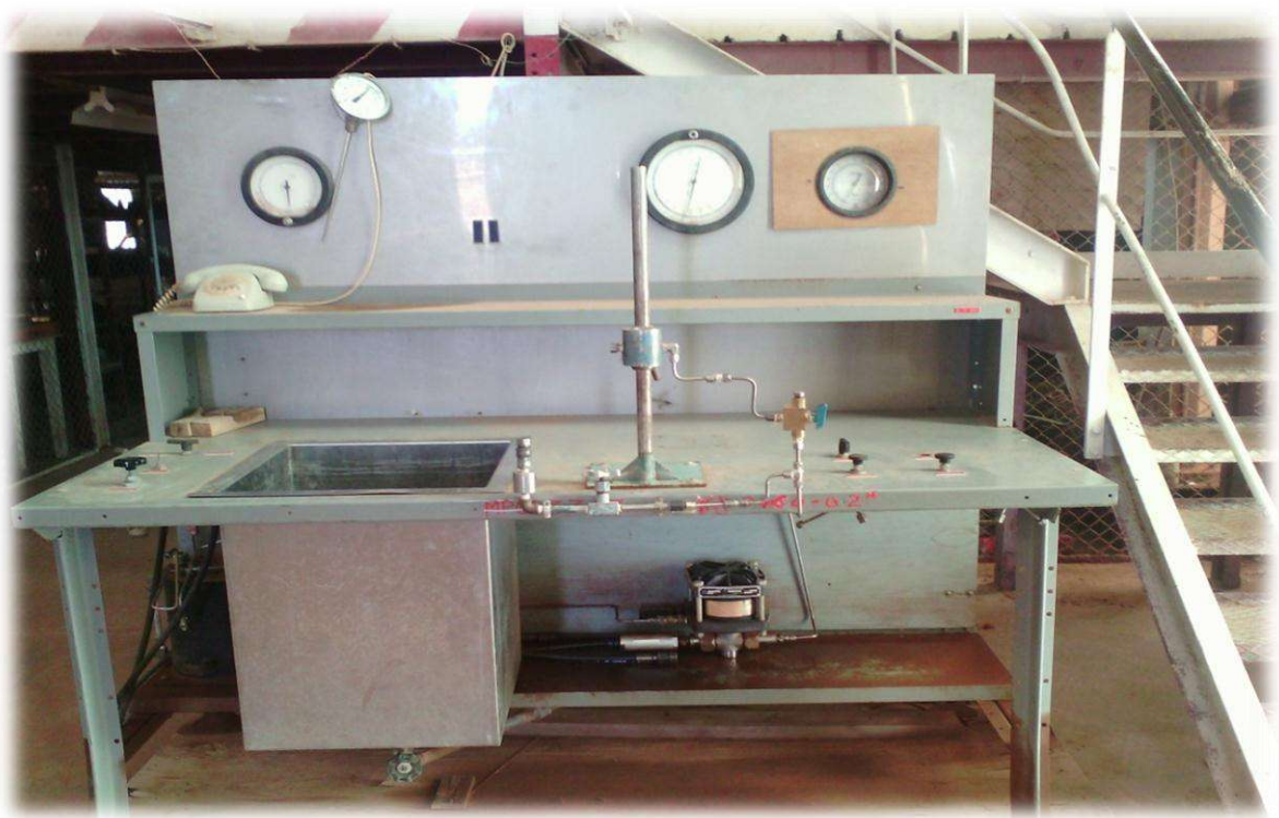
Figure.VI.12 Banc de tarage en atelier Merksem [1]
