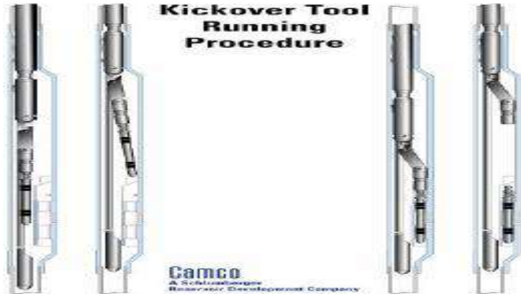
Figure IV.8 : opération de mise en place d'une vanne de GL par un kick over [6]
