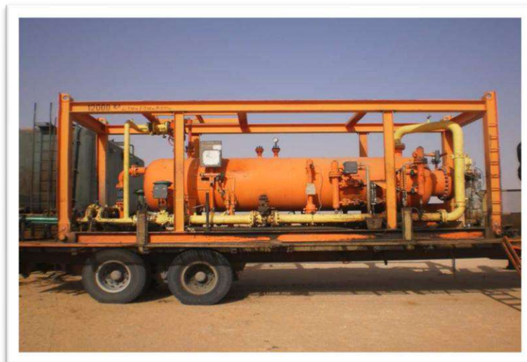
Figure IV.2 Unité de jaugeage avec séparateur et Bac de stockage[13].
