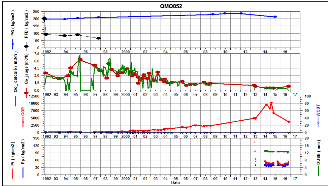
Figure V. 1 : Les Graphes pression de gisement PG , débit d'huile Q_o ,GOR ;pression tête P_t ,pression pipe P_p (OMO852).
