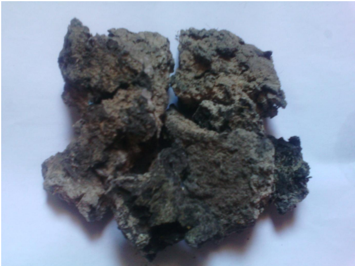
Figure IV.1 : la boue sèche de station d'épuration de Touggourt.
