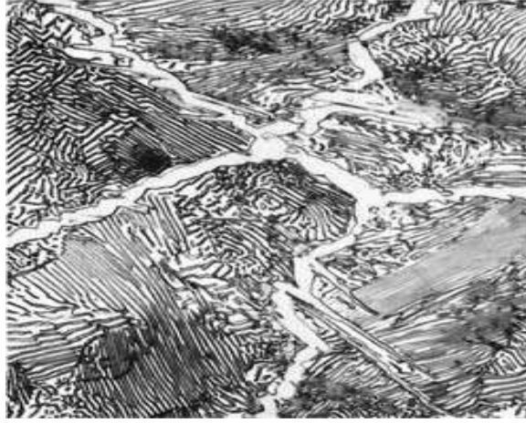
الشكل(5): البنية المجهرية لفولاذ بعد اوتكتويدي
