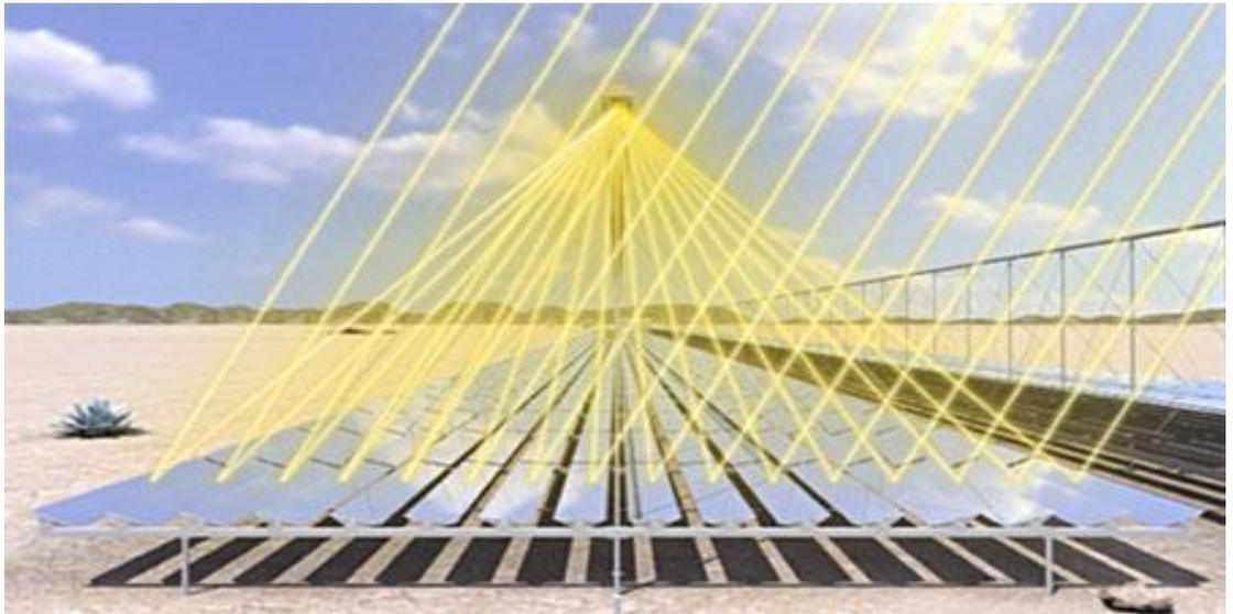
**Fig. I.6 :** Schéma de principe d'un linéaire Fresnel [9].
