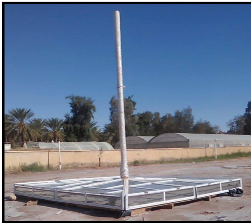
Fig. 14: Image de prototype de cheminée solaire Ouargla 1
