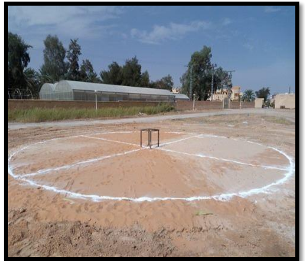
Fig. 24: couche de sable 0.1m
