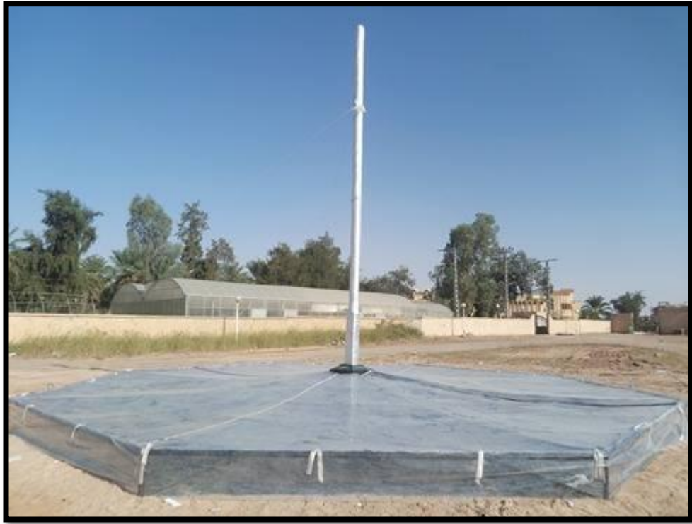
Fig. 17 : Image de prototype de cheminée solaire Ouargla 2
