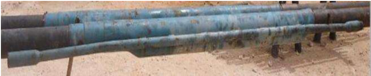
Figure III.1. SPM pour GAZ-LIFT camco
