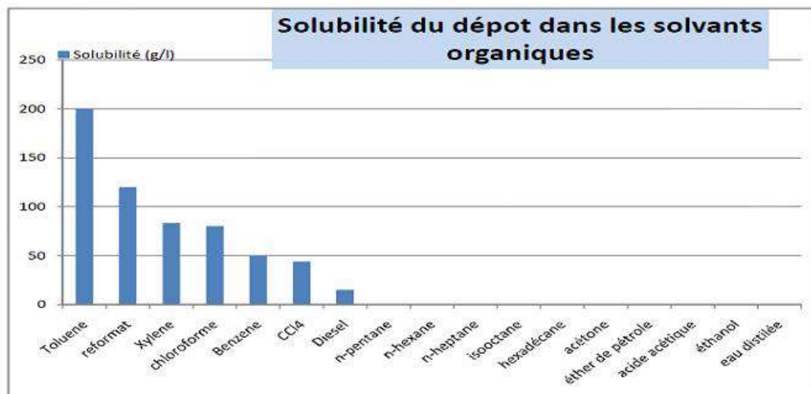
Figure 2.3 : Solubilité des Asphaltènes dans les différents solvants (6)
