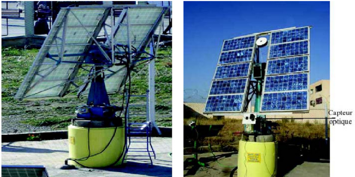
Figure II-11 : Vue du dispositif de poursuite AURESOLAR
