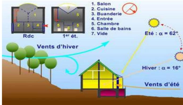
Figure 1-8: Illustration de quelques principes d'architecture bioclimatique (implantation et organisation spatiale) [10]
