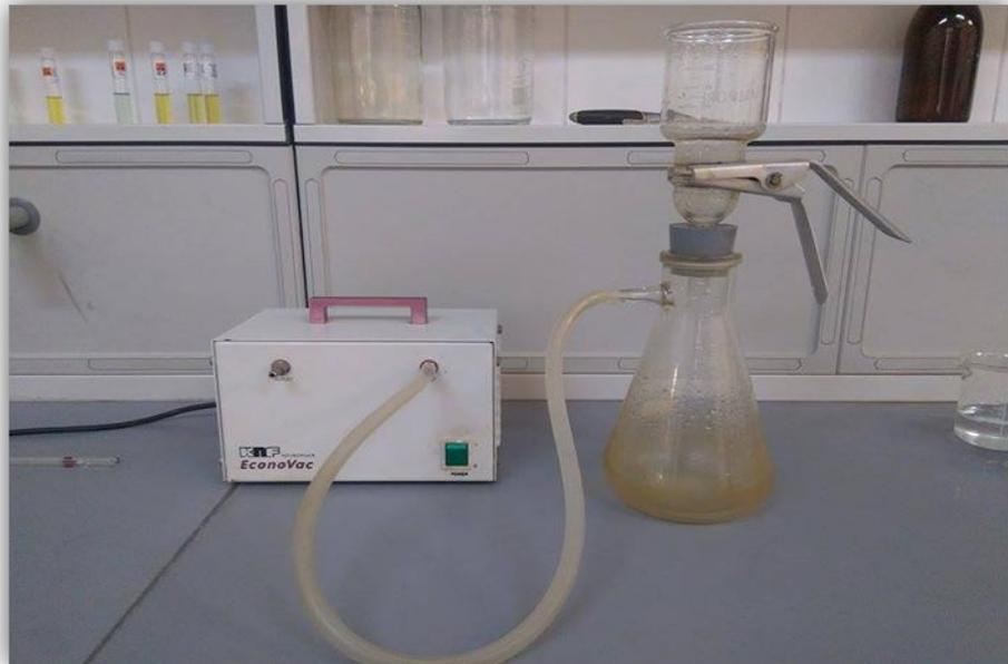
**Figure III. 6 : Dispositif de filtration sous vide****❑ Mode opératoire [19] :**
