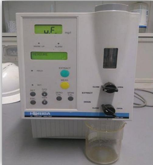
**Figure III. 7 : Appareil de mesure de la teneur en hydrocarbures HORIBA**
