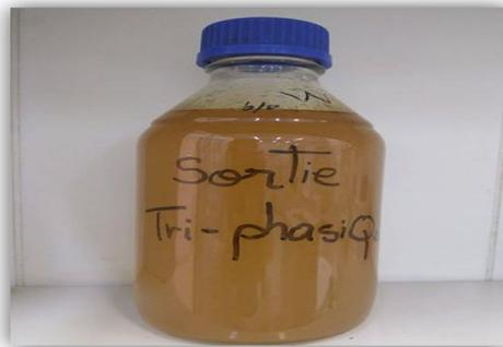
**Figure III. 3: Échantillon prélevé à la sortie de Séparateur triphasique**
