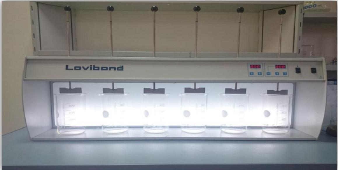
**Figure III. 9: Jar Test**
