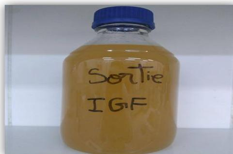
**Figure III. 4 : Échantillon prélevé à la sortie de DGF/ IGF**
