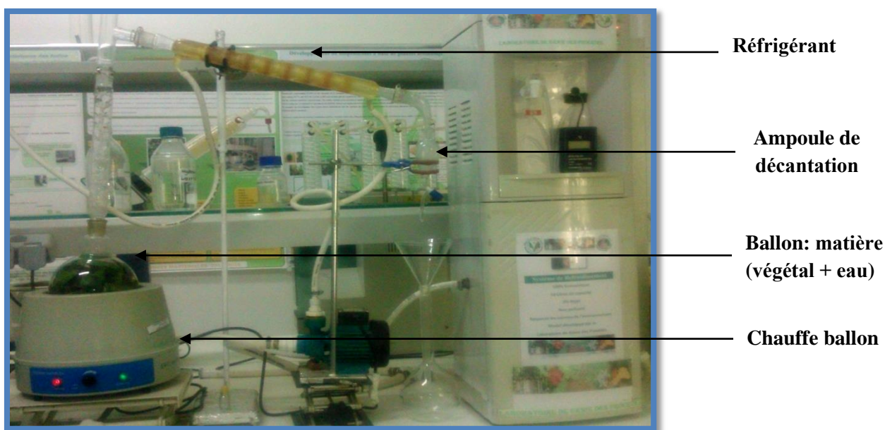
Fig.11 : montage d'hydrodistillation utilisé lors d'extraction
