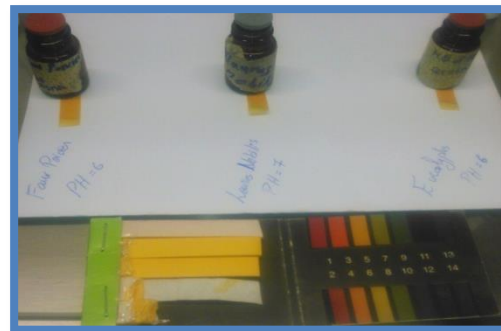
Fig .13 : détermination du pH
