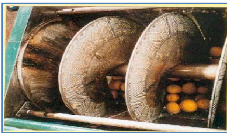
Fig. 04 : presse hydraulique pour la méthode d'expression à froid
