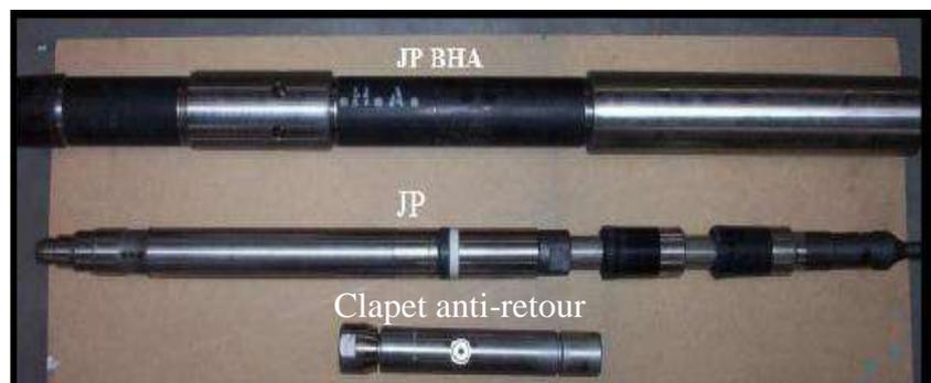
**Figure III.6 :** Le BHA, Jet Pompe et le clapet anti-retour
