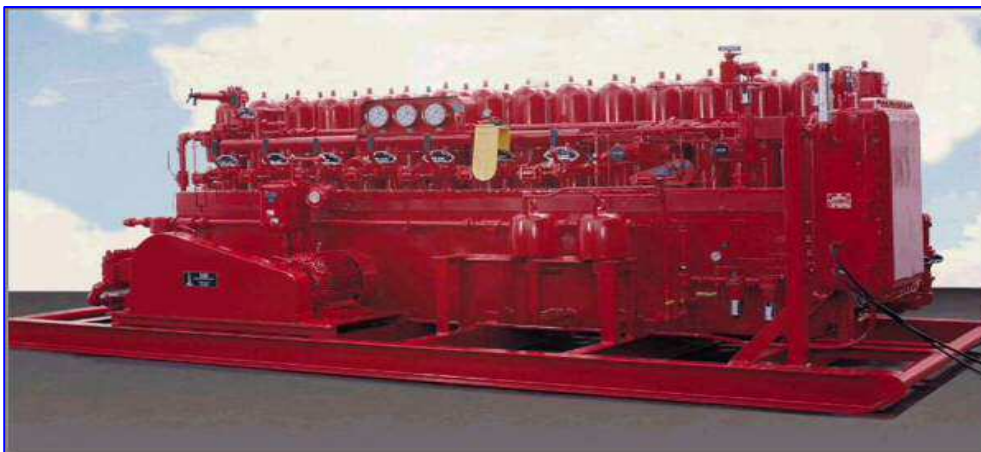
Figure II.16 : Unité hydraulique de commande.
