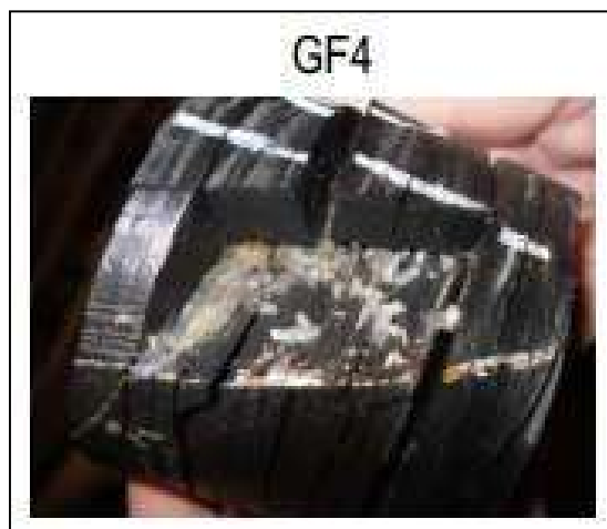
Figure 1.12 Fracture observé dans le carottage
