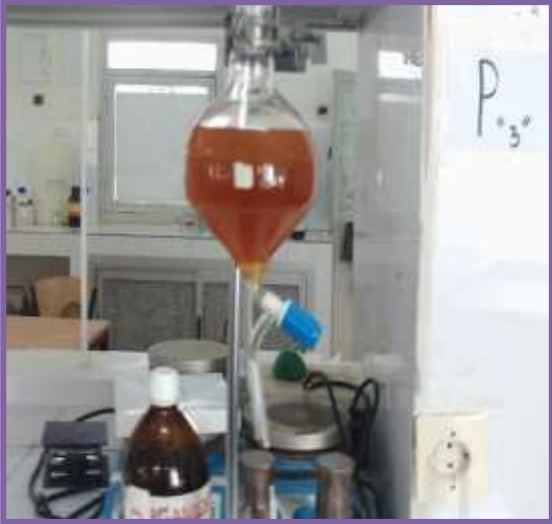
الشكل (IV-2) : الاستخلاص بثنائي كلور الميثان
