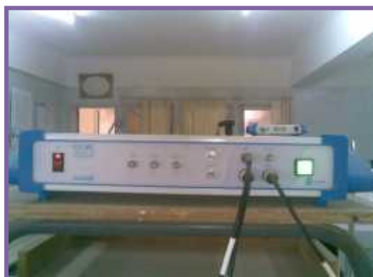
الشكل (IV- 6) : جهاز Potentionstat - Galvanostat من نوع PGZ 301.
