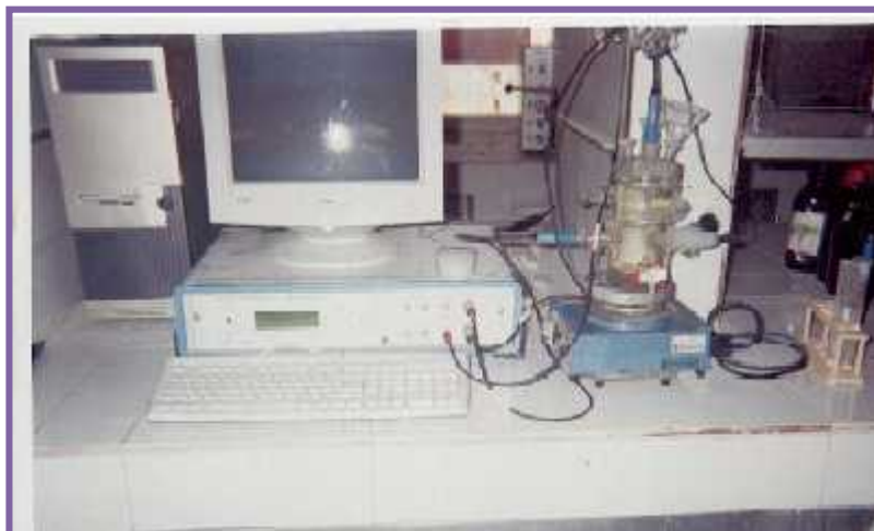
الشكل (IV-11) : التركيب التجريبي لطريقة تافال.
