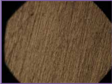
صورة مقربة للفولاذ قبل التآكل
