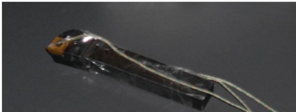
Figure I.27 Les thermocouples type K sont montés sur l'outil de coupe [32]
