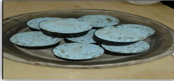
Figure (IV.4): Exemple d'éprouvettes Marshall
