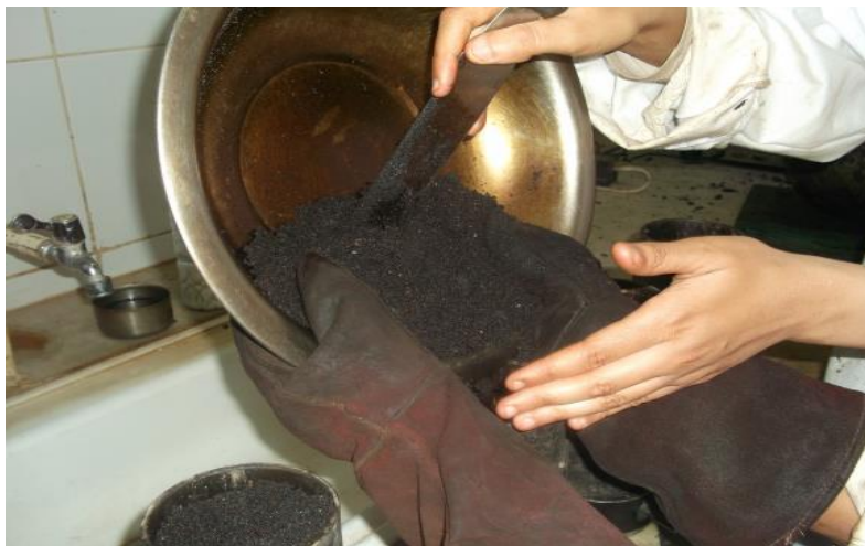
Figure (IV.9): Remplissage du moule
