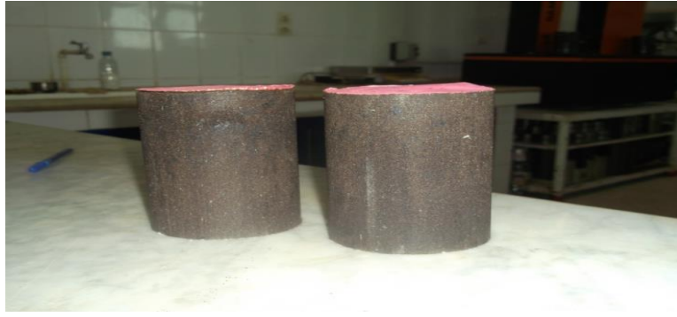
Figure (IV.8): Exemple des éprouvettes confectionnées de l'essai Duriez
