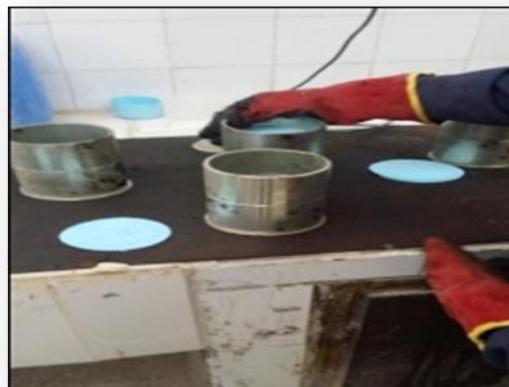
Figure (IV.5): Remplissage du moule
