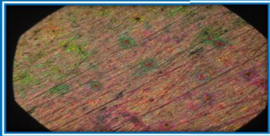
صورة مقربة للفولاذ الكربوني عند تأكله بعد الإضافة (10ml)
