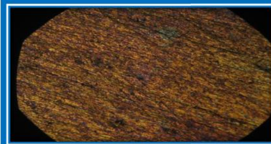
صورة مقربة للفولاذ الكربوني عند تأكله بعد الإضافة (30ml)
