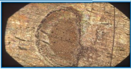
صورة مقربة للفولاذ الكربوني عند تأكله بعد الإضافة (20ml)
