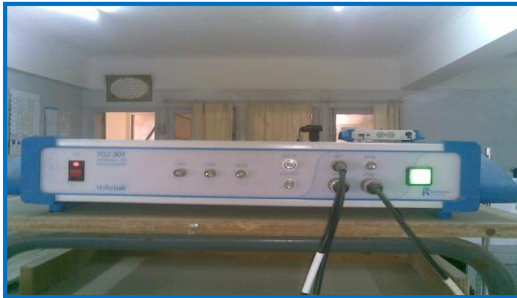
الشكل (7-IV) : جهاز Potentionstat - Galvanostat من نوع PGZ 301.
