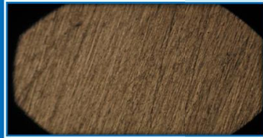
صورة مقربة للفولاذ الكربوني قبل تأكله
