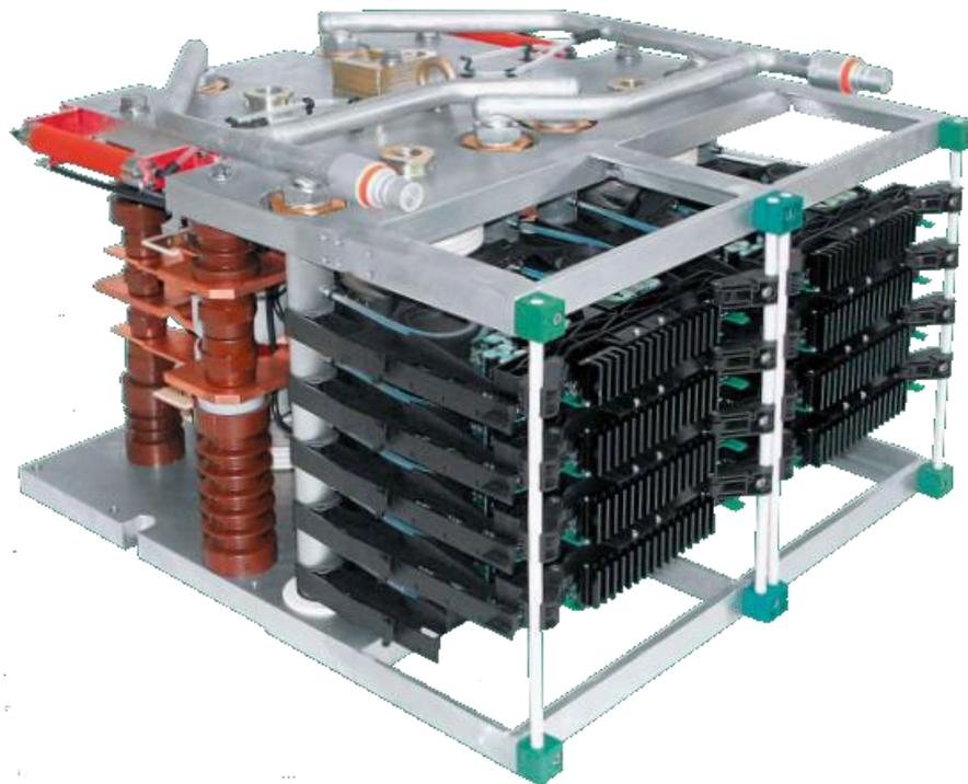
Figure II-1: Onduleur à niveaux multiples
