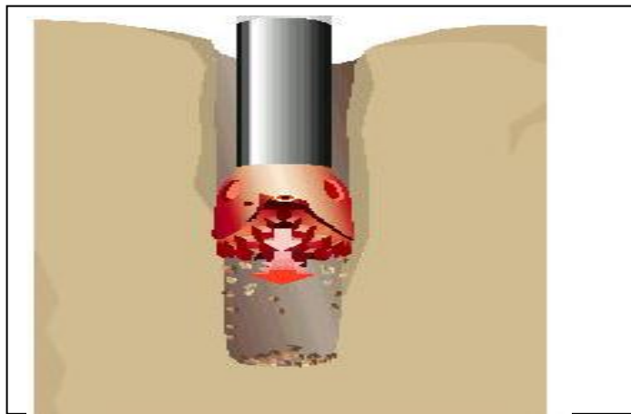
Figure II.15 : Diminution du diamètre nominal du trou. [7]
