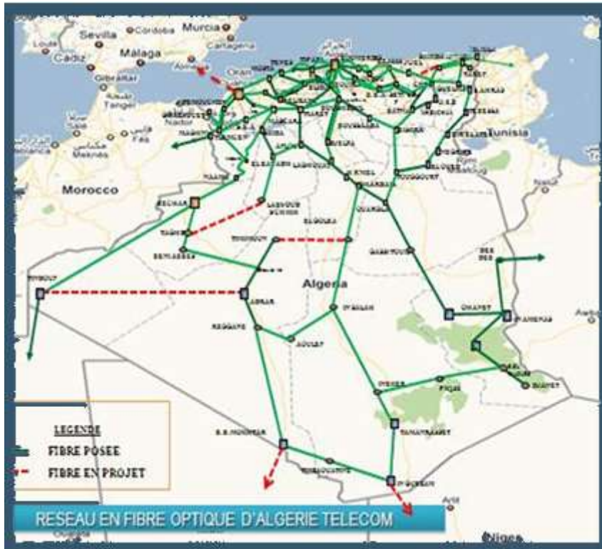
Figure I. 1 :RESEAU EN FIBRE OPTIQUE D'ALGERIE TELECOM
