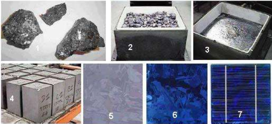
Figure (I. 8) : Etape de fabrication des cellules : (1) minerai de Silicium – (2) raffinage (pour augmenter la pureté) – (3) Silicium en fusion donnant des lingots (4) après solidification – (5) wafer obtenu par sciage du lingot – (6) traitement de surface par procédés physico chimiques et (7) cellule finie avec électrodes.
