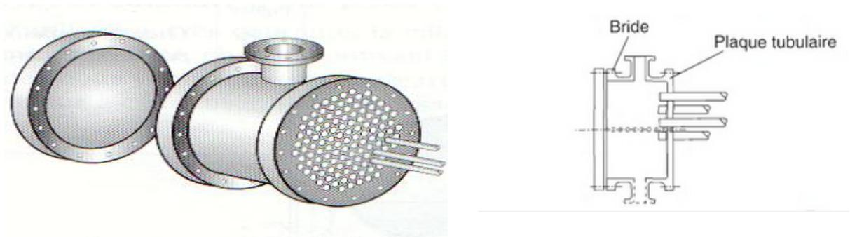
Figure II.1.2. Figure d'une plaque tubulaire
