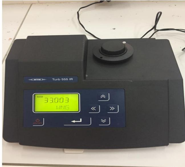
**Figure (III-9) :** Turbidité-mètre
