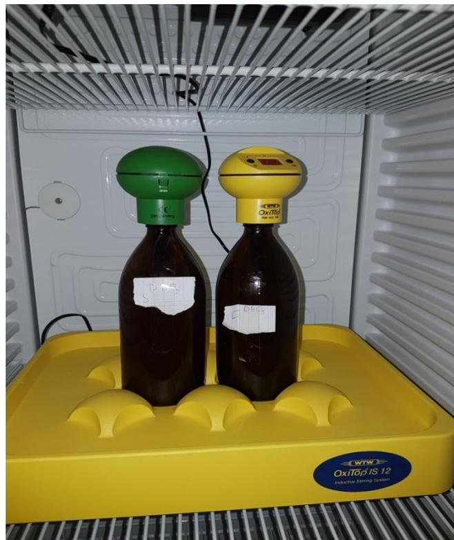
Figure (III-5) : DBO-mètre utilisé
