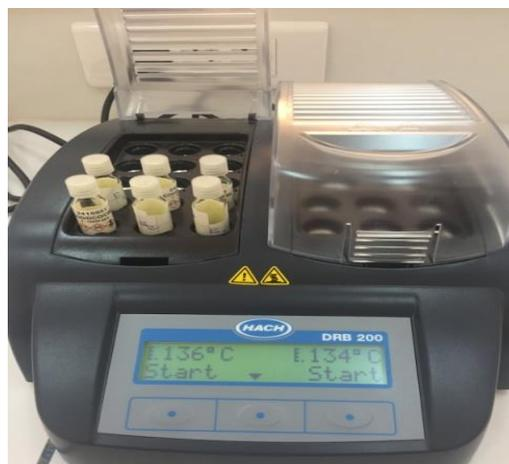
**Figure (III-7)** : Réacteur (HACH-DRB 200)
