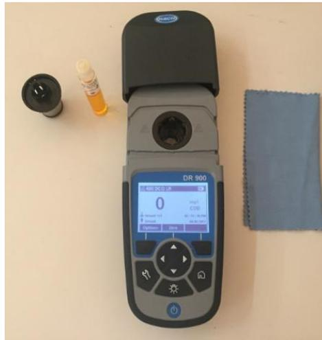
**Figure (III-8) :** photomètre HACH -DR 900
