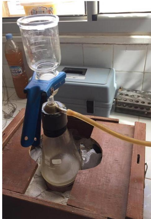
**Figure (III-12) : Equipement de filtration sous vide**
